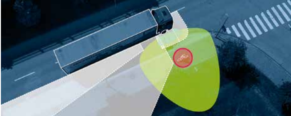
Die Lkw der Kommunalbetriebe Steyr wurden mit einem Kamerasystem ausgestattet, mit dem der Fahrer erkennen kann, ob sich beim Abbiegevorgang Personen im sogenannten toten Winkel aufhalten.
