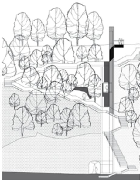
Der neue Lift auf den Tabor wird die Hälfte der etwa 35 Höhenmeter im Freien zurücklegen und bietet dabei den Passagieren einen beeindruckenden Ausblick auf die Steyrer Altstadt. Die Liftkabine kann bis zu 2000 Kilogramm oder 26 Personen befördern, sie bewegt sich mit 3,6 Kilometern pro Stunde. 180 Fahrten pro Stunde sind möglich. Die Aufstiegshilfe ist mit einem umweltfreundlichen, energiesparenden Treibscheiben-Antrieb ausgestattet.
