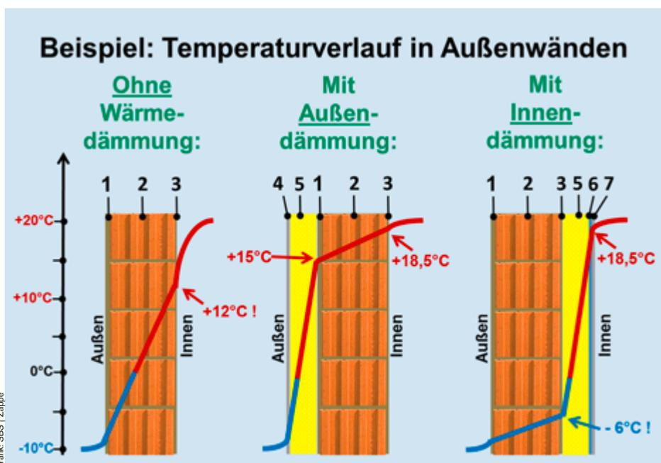
Die Grafik zeigt die Vorteile der Wärmedämmung: Die raumseitige Oberflächen-Temperatur steigt und die Behaglichkeit wird erhöht.
