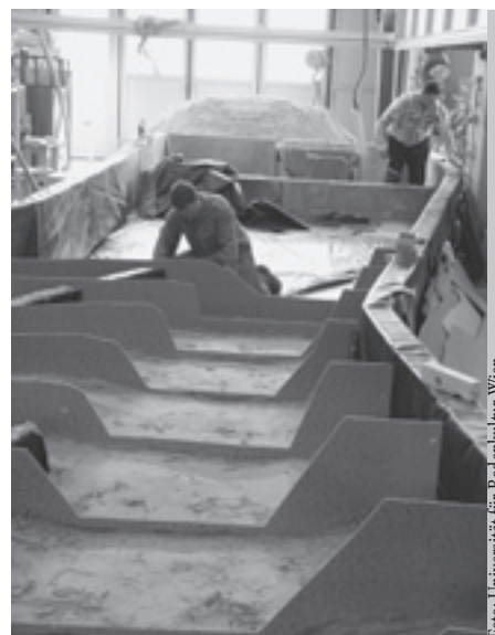
In der Unterhimmler Au ist ein Entlastungsgerinne als Geschiebefang für die Steyr geplant. Die Universität für Bodenkultur in Wien erarbeitet dafür ein Modell (Bild).
