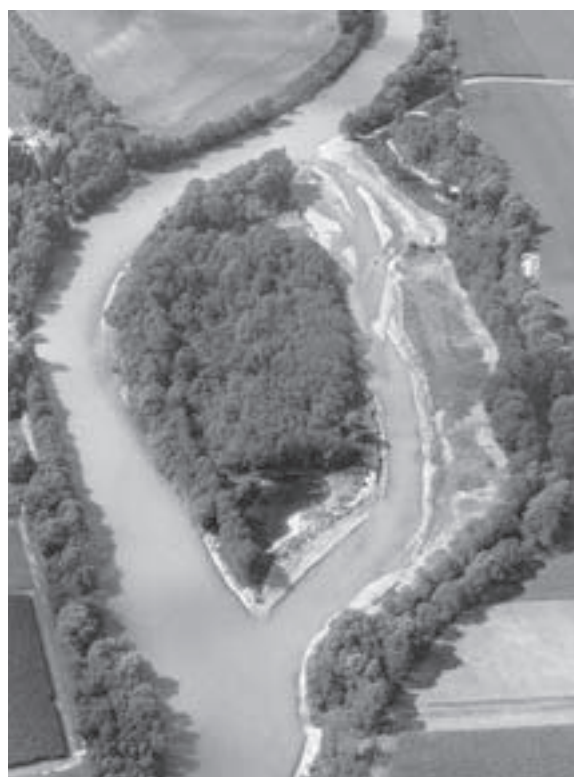
Aufweitung der Drau in Kleblach-Lind (Kärnten): Ein Beispiel für eine gelungene Verbindung von Hochwasserschutz, Geschiebe-Bewirtschaftung, Naturschutz und Naherholung. Diese Lösung wäre auch in der Himmlitzer Au eine mögliche Variante für die Anlage eines Nebenarms der Steyr.
