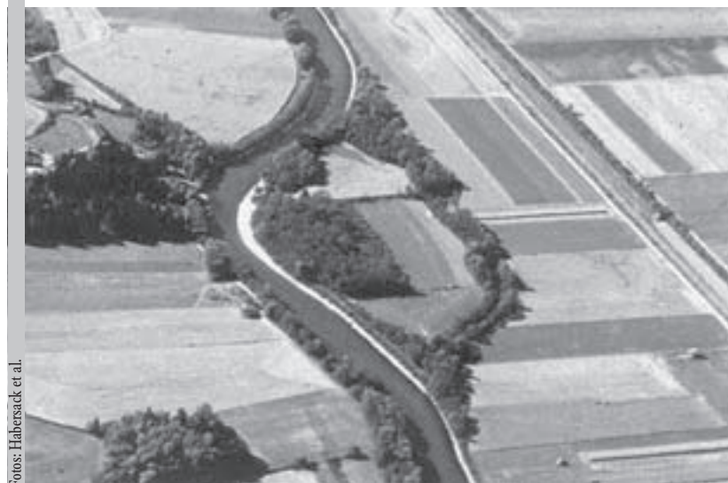
Aufweitung der Drau in Kleblach-Lind (Kärnten): Ein Beispiel für eine gelungene Verbindung von Hochwasserschutz, Geschiebe-Bewirtschaftung, Naturschutz und Naherholung. Diese Lösung wäre auch in der Himmlitzer Au eine mögliche Variante für die Anlage eines Nebenarms der Steyr.
